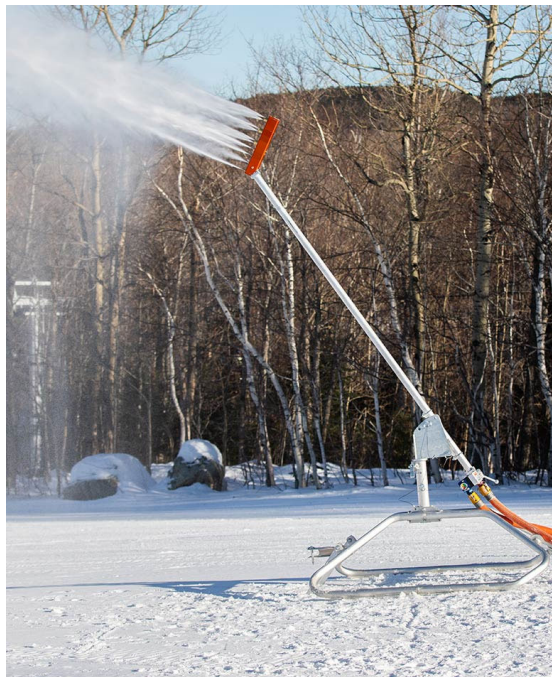
Figure 4-4 : Exemple de canon avec jet directionnel étroit ( https://www.hkdsnowmakers.com/fr/ )
