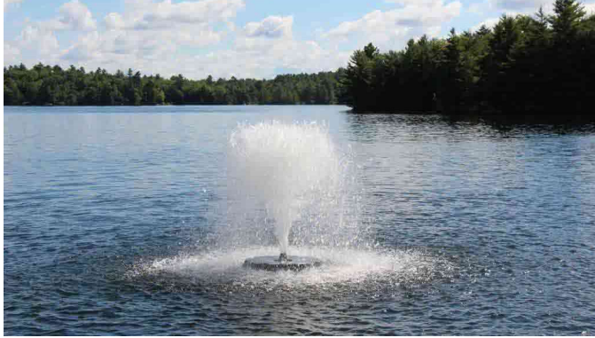
Figure 4-5 : Exemple d'aérateur de surface ( www.arbrux.com ).
