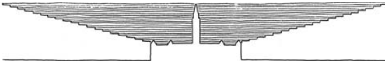
Figure 14. – Représentation des plafonds de hauteur en gradins de pente 1 : 4 à partir de la ligne de faite de l'édifice du Centre (étude Hammer).
