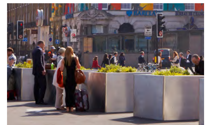
FIGURE 148. MESURES ANTI-BÉLIERS INTÉGRÉES AUX CARACTÉRISTIQUES DU PAYSAGE, HOMEPLANTERS Source: Securiscap
